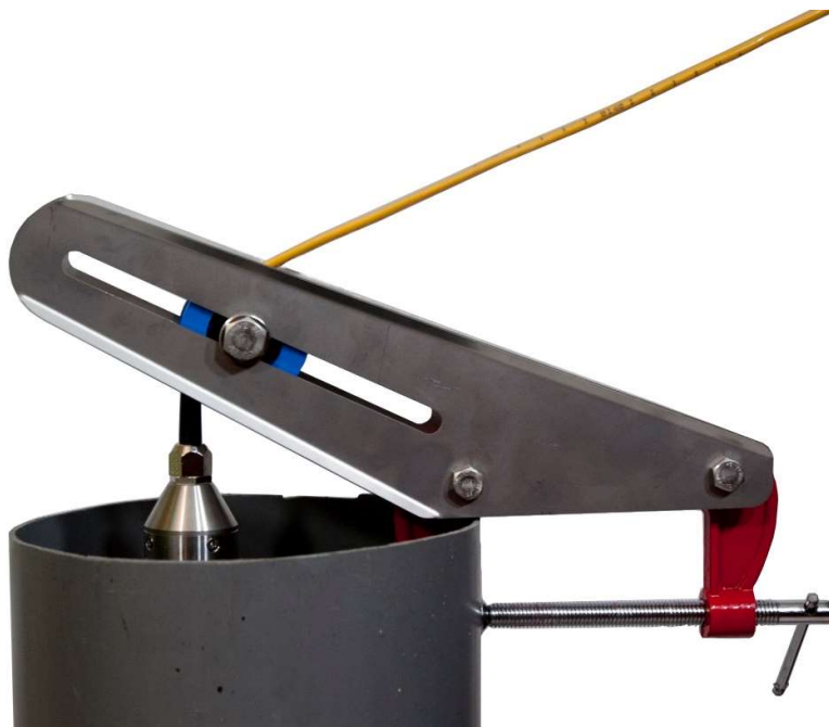
FIGURA 3 – LA POSIZIONE DELLA PULEGGIA BLU PUÒ ESSERE REGOLATA MANUALMENTE
