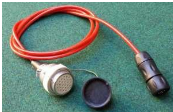
Cavo adattatore dal pannello del GFA a connettore sismografo (standard NK2721C – altre opzioni a richiesta)
