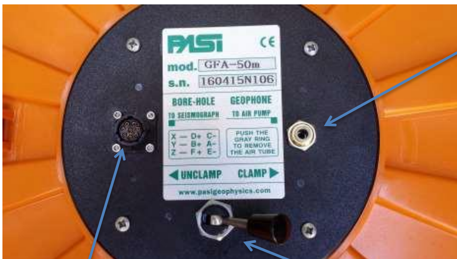
Figura 3: Ingresso pompa aria: collegare il tubo dell'aria e avviare il pompaggio
