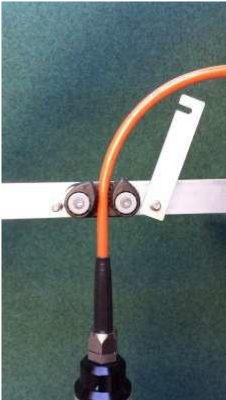
FIG. 1 Strozzascotte in posizione aperto
