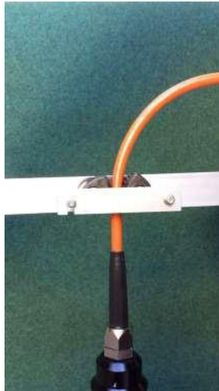
FIG. 2 Strozzascotte in posizione chiuso
